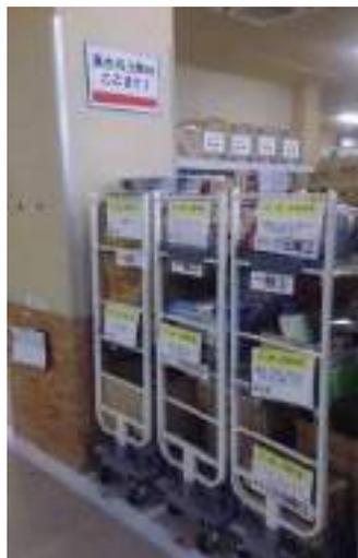
高さ制限の線を掲示し、台車の高さが適正かの判断が容易となっています。置場は線で区画し、容易に整頓ができるようにしています。
