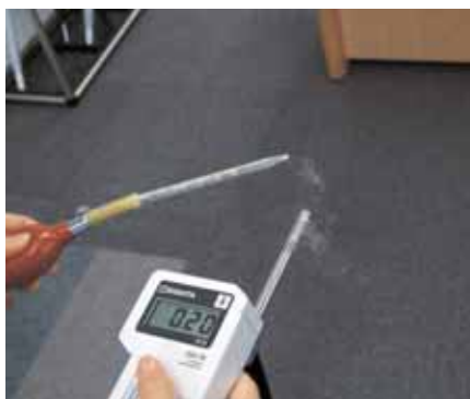
スモークテスターと風速計の使用状況
