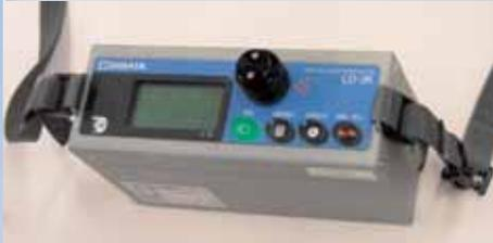
相対濃度指示方式の粉じん計を使用すれば、健康に影響を及ぼす作業場内の粉じんや溶接ヒューム、たばこの煙の濃度を比較的簡単に測定することができます。ここでは、当センターが保有するレーザー式デジタル粉じん計( LD-3K )を中心に操作方法を紹介します。
